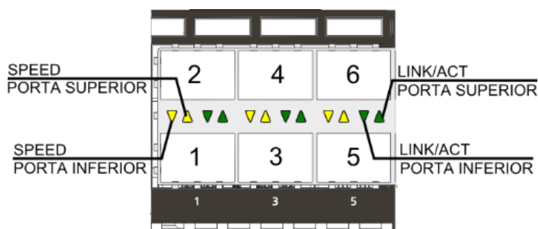
Figura 8 - Portas 1GbE SFP LEDs
